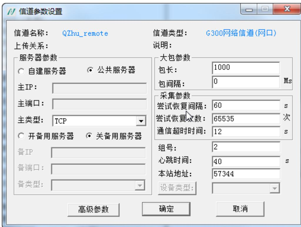
图 4-8 远程通网络信道（网口）参数设置
