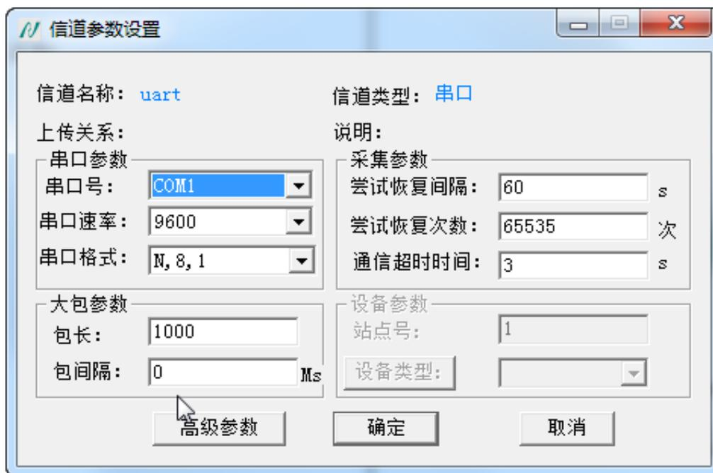
图 4-5 串口信道参数设置
