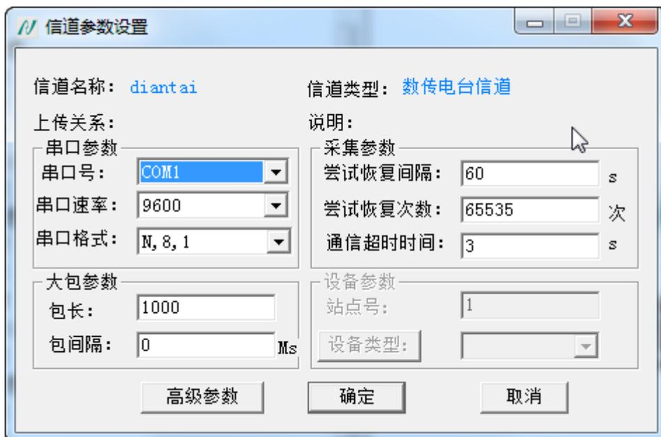
图 4-9 外接模块信道参数设置
